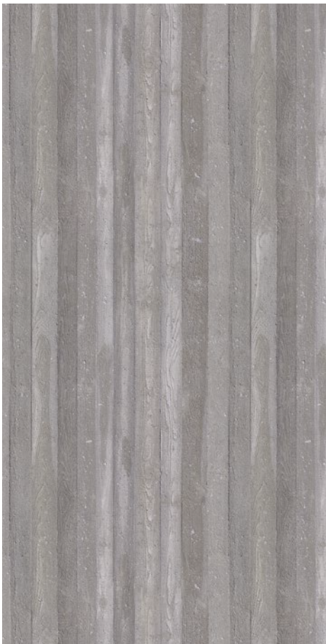
Beton Brettschalung * WO
